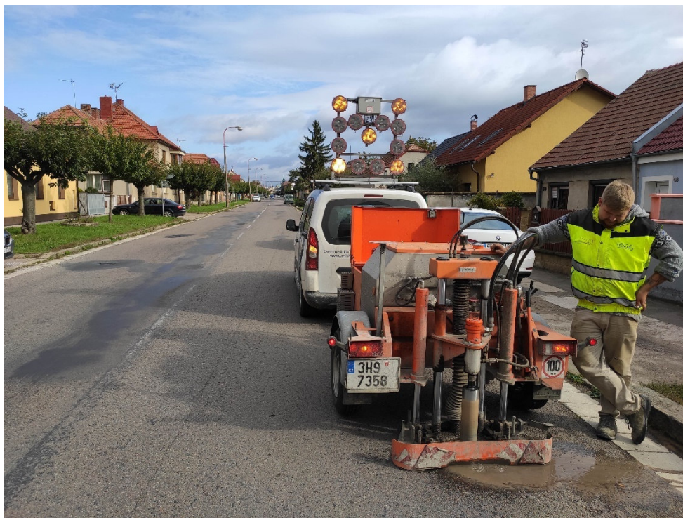
Vrtání vývrtu č.9
