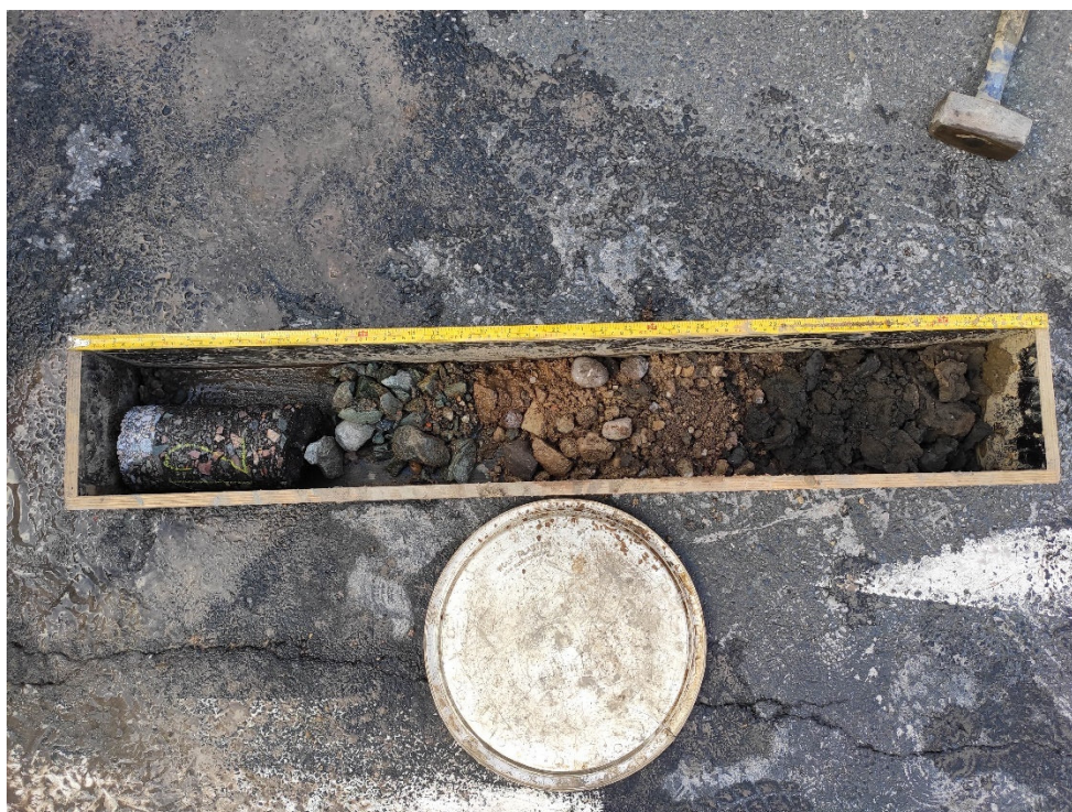
V12 – S12 (sonda na stavbě)
